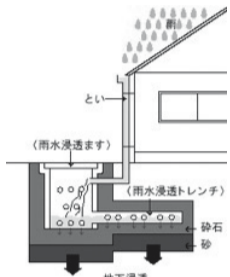
雨水浸透ます・雨水浸透トレンチ
