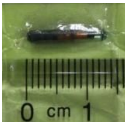
マイクロチップの写真（約2mm×8～12mm）
